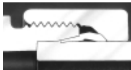
Schneidring - Deformation bei Überanzug Cutting ring - Deformation from excessive tightening Bague coupante - Déformation par serrage excessif
