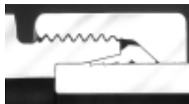
Zweischneidring - Deformation bei Überanzug Two-edge cutting ring - Deformation from excessive tightening Bague coupante double - Déformation par serrage excessif
